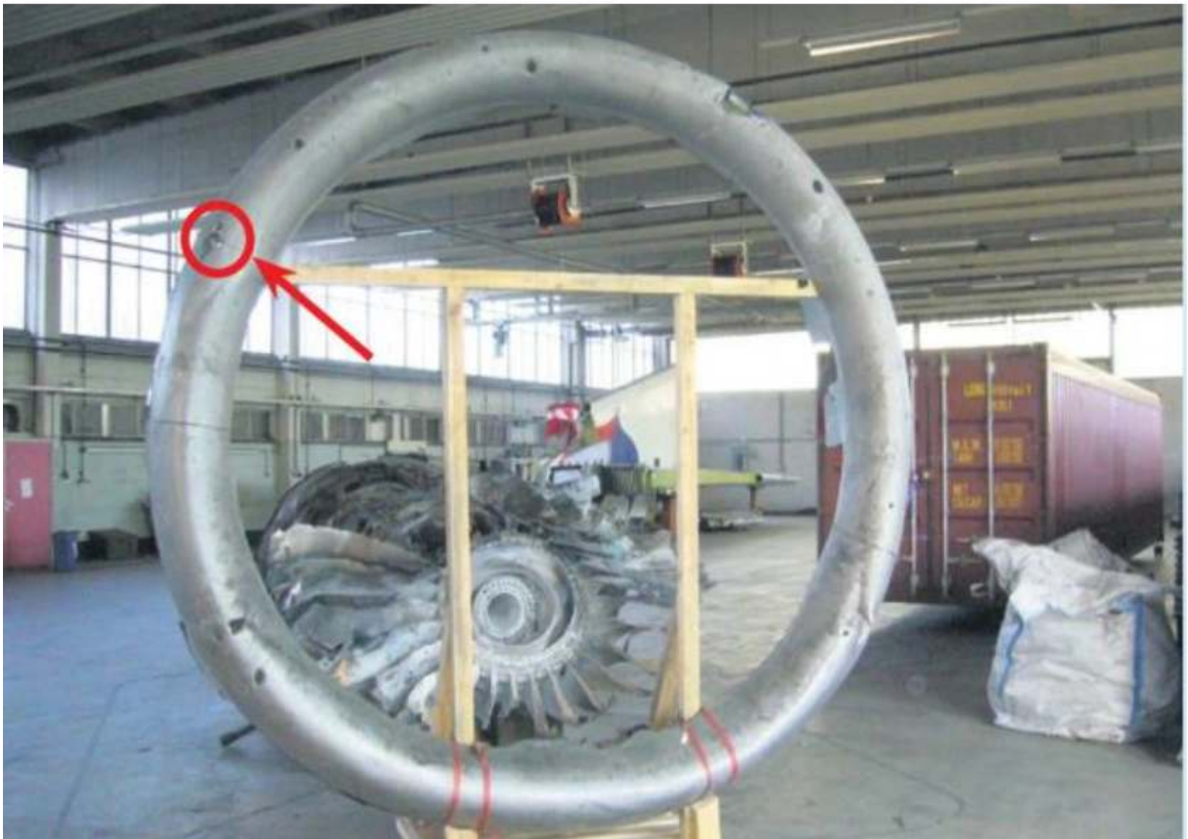
تحلیل آسیب حلقه ورودی موتور چپ
